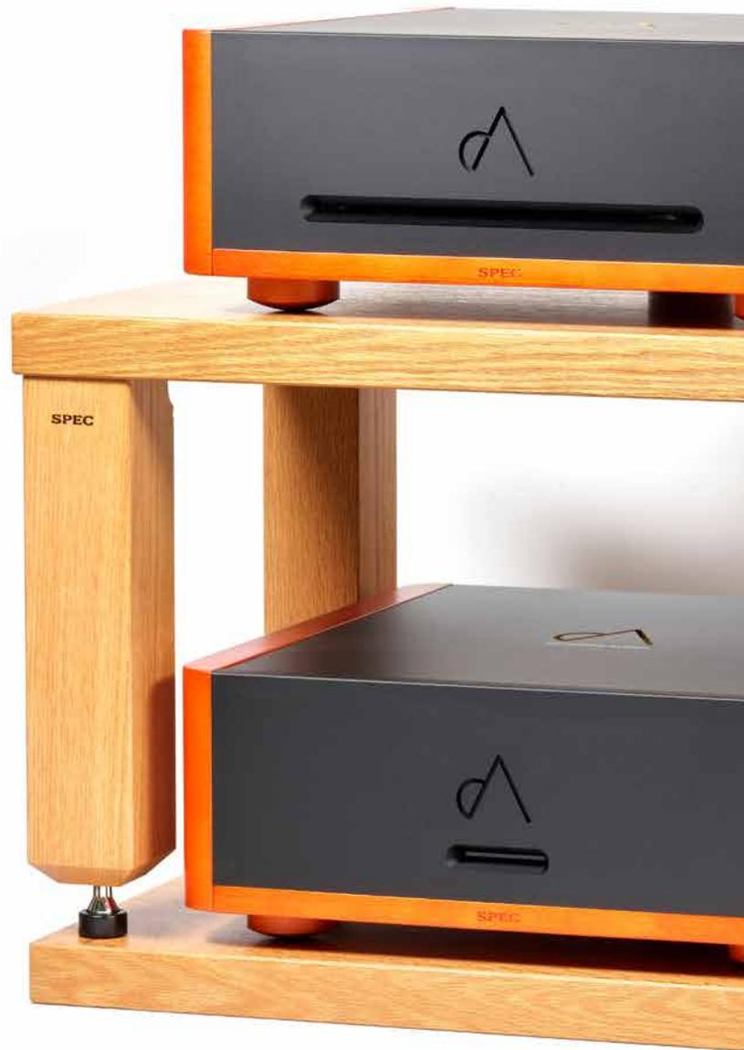
Ein überragend guter Verstärker mit klassengerechtem Verlangen nach Raum und Entfaltung: SPEC Monos sind in vier praktisch identischen Gehäusen, zwei Netzteilen (unten) und zwei Verstärkermodulen (oben) untergebracht. Die Tische und Basen stellte uns der Vertrieb als Prototypen dazu ... sie harmonieren klanglich hervorragend mit den exzellenten Amps und gefielen uns auch optisch mit jedem Tag besser.
